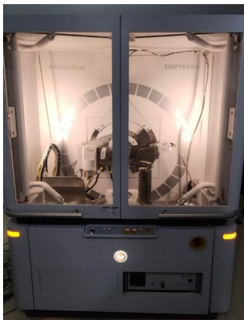
Figure 24 : Appareil de caractérisation DRX (PanalyticalEmpyrean).
