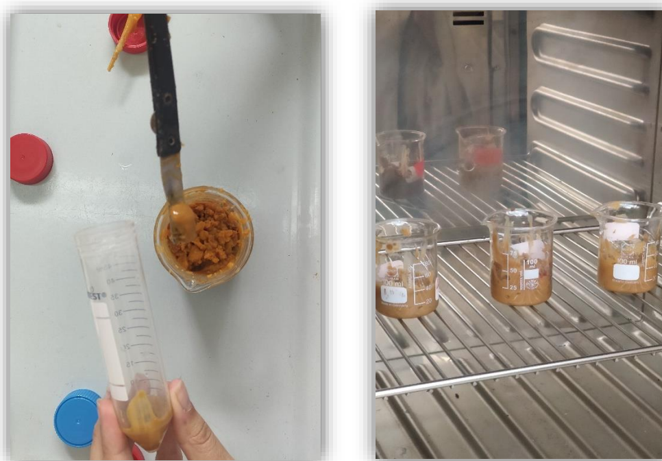
Figure 17 : Récupération et séchage du culot.
