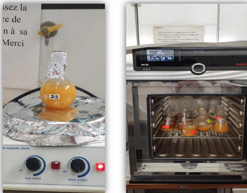
Figure15 : Agitation magnétique et séchage des échantillons.
