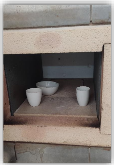
Figure 18 : Chauffage des échantillons dans un four à moufle.
